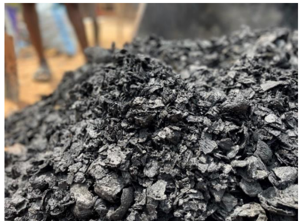
カカオポッドの殻を集めてバイオ炭をつくる
